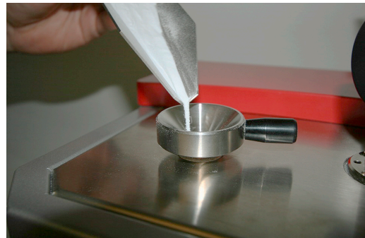
Für eine MVR Messung wird Polyamid 12 Pulver in den Prüfkanal gefüllt (Bildquelle ZwickRoell)
