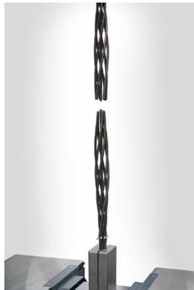
Litzenprüfungen im elektromechanischen Zugversuch (Bildquelle ZwickRoell)
