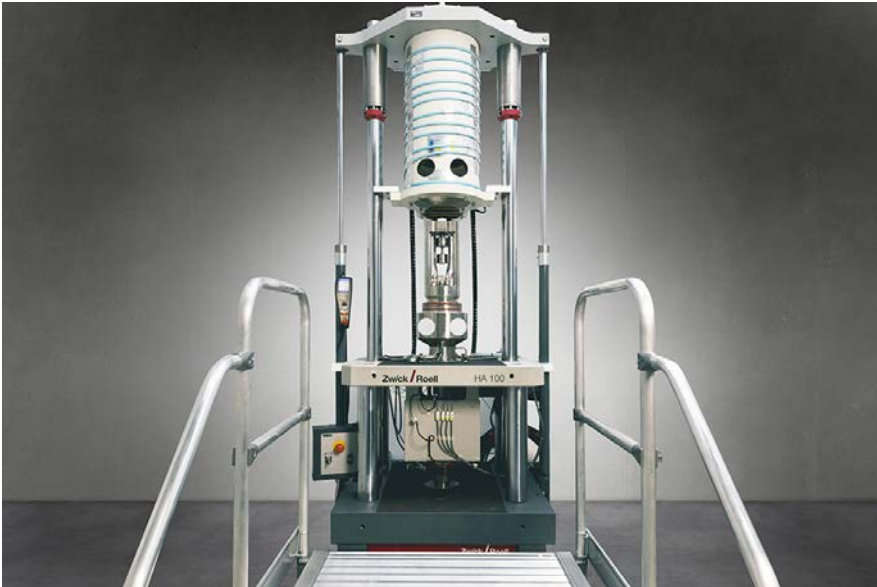
Servohydraulische Prüfmaschine HA 100 mit Wasserstoffbehälter (Bildquelle MPA)
