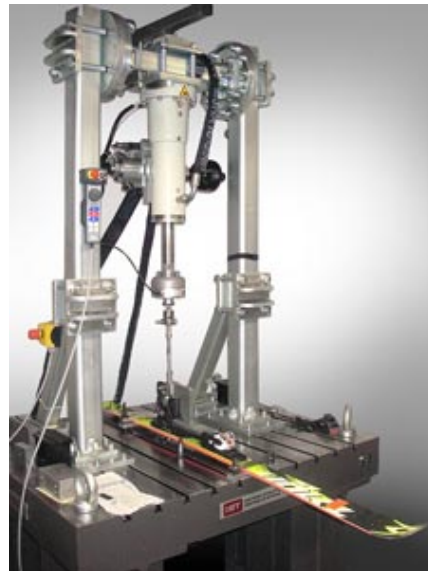
Prüfen einer Marker Skibindung mit einer servohydraulischen Prüfmaschine
