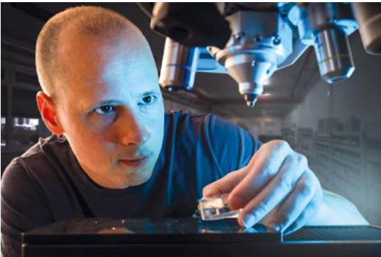
Vorbereitung der Härteprüfung (Bildquelle: ZwickRoell)
