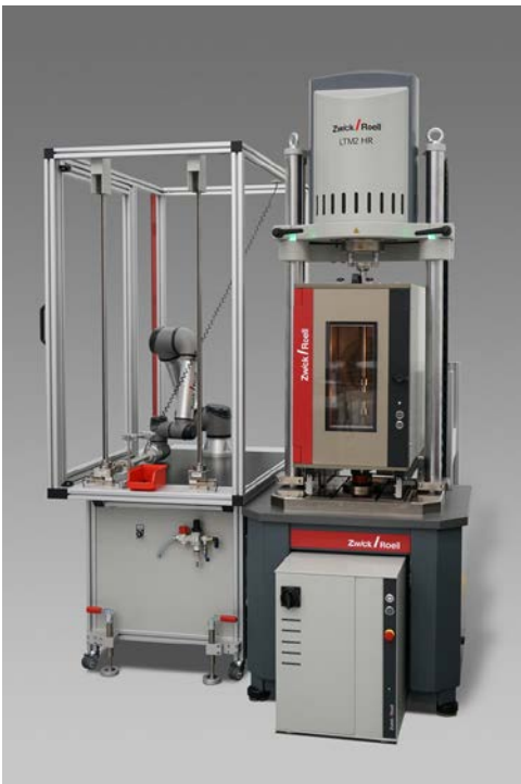
ZwickRoell roboTest N mit LTM 2 zur Charakterisierung von Industrieruß-Polymer-Gemischen (Bildquelle: ZwickRoell)
