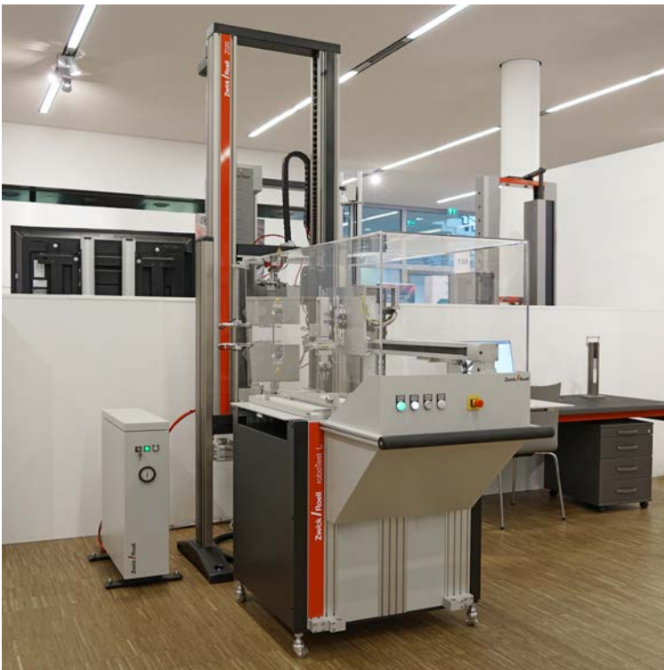
ZwickRoell roboTest L und Z010 AllroundLine Prüfmaschine für Versuche an Elastomerproben bei Covestro (Bildquelle: ZwickRoell)
