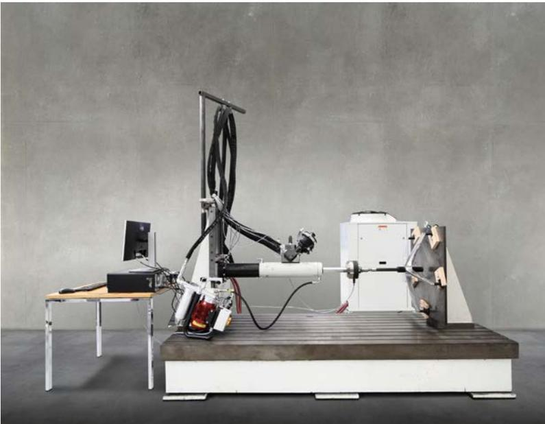
Die weitreichende Modernisierung des servohydraulischen Prüffeldes der Firma Schenk umfasste neben den Hauptkomponenten auch den Servoregler Control Cube von ZwickRoell und die Prüfsoftware Cubus Light.
