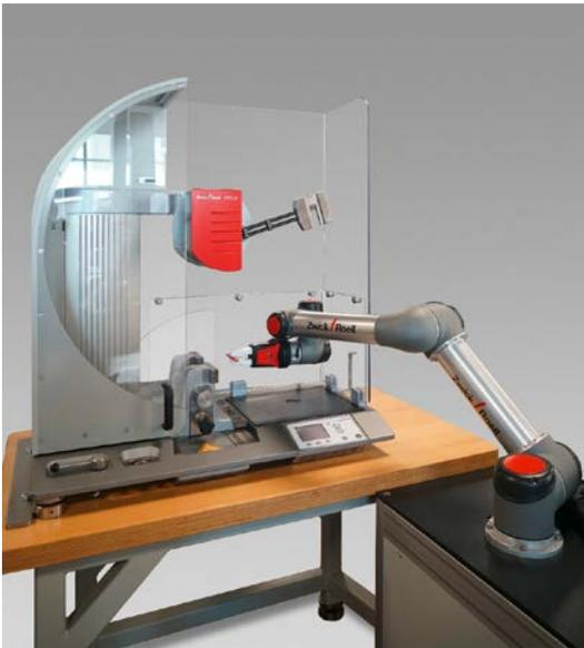
Mit roboTest automatisierter Kerbschlagbiegeversuch an einem HIT-Pendelschlagwerk
