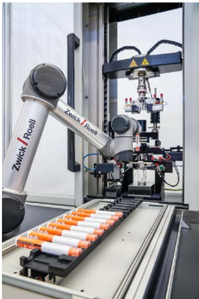
Roboter beim Einlegen der Autoinjektoren in die Prüfmaschine
