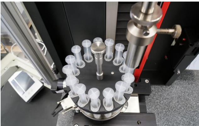
Prüfvorrichtung mit einem Rotationsmagazin, einer semi-automatischen Zuführeinheit (Bildquelle Zwick Roell)
