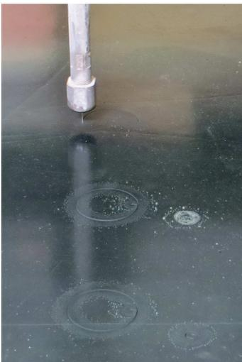
Purwasserschneiden von Gummi
